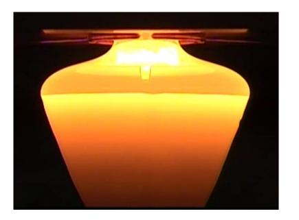
Mono-crystalline FZ-test using SPB Silicon 使用SPB硅进行单晶悬浮区熔测试
