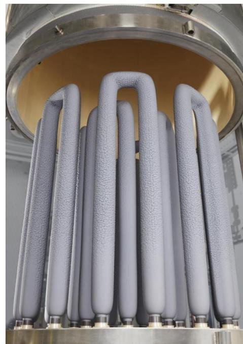
*Поликремниевые стержни после осаждения из газовой фазы*
