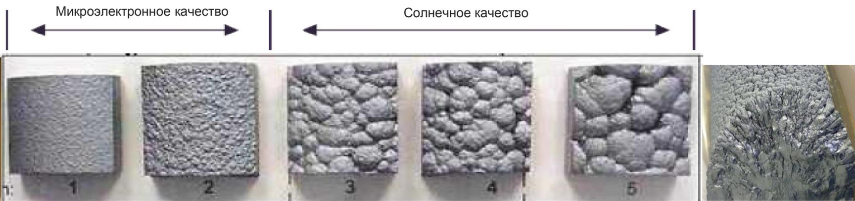
*Вид структур стержней из поликремния солнечного и микроэлектронного качества*
